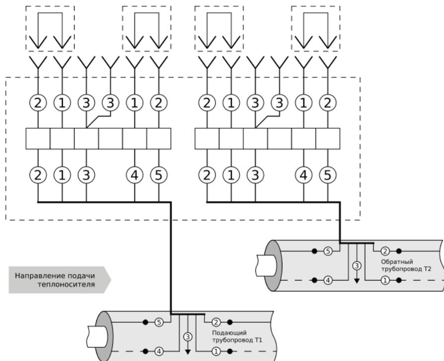
Рис. 5. Разъединение/закольцовка одной двухтрубной системы ОДК
