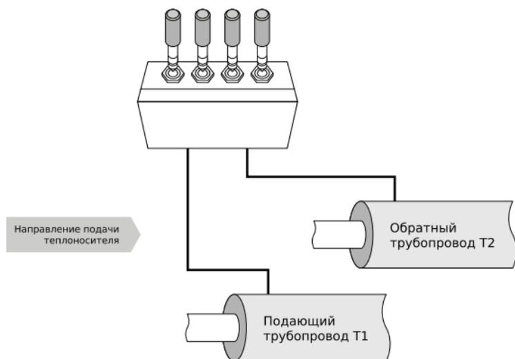
Рис.3. Разъединение/закольцовка одной двухтрубной системы ОДК
