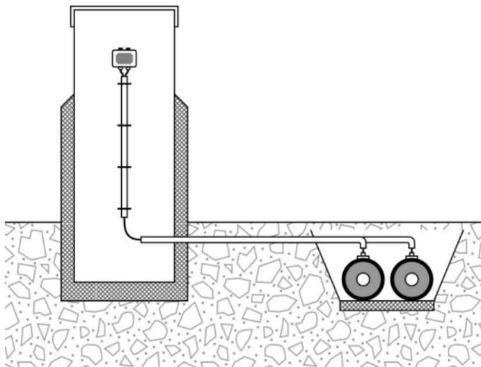
Рис. 6. Установка терминала в наземном ковре
