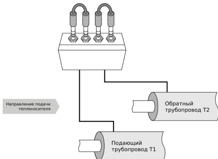
Рис. 2. Соединение одной двухтрубной системы ОДК
