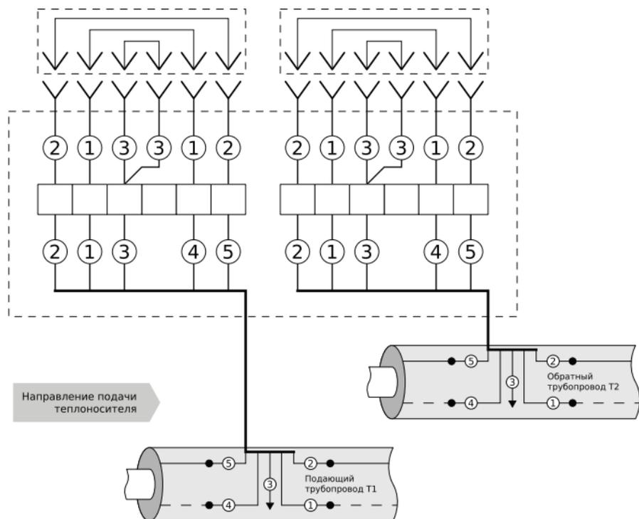
Рис. 4. Соединение одной двухтрубной системы ОДК
